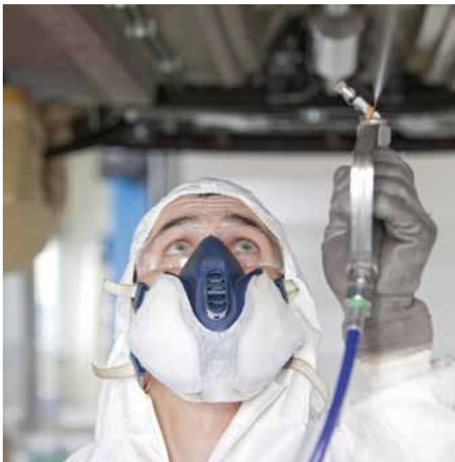
Mitarbeiter in Sicherheitskleidung bei der Pkw-Hohlraumversiegelung
